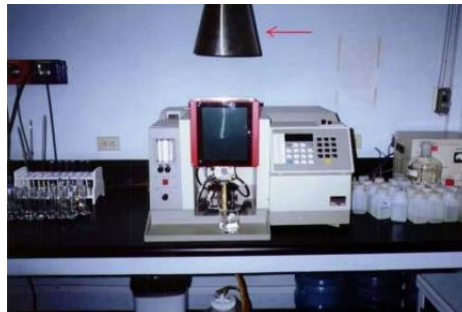
Ilustración 2: Sistema de ventilación localizada.
