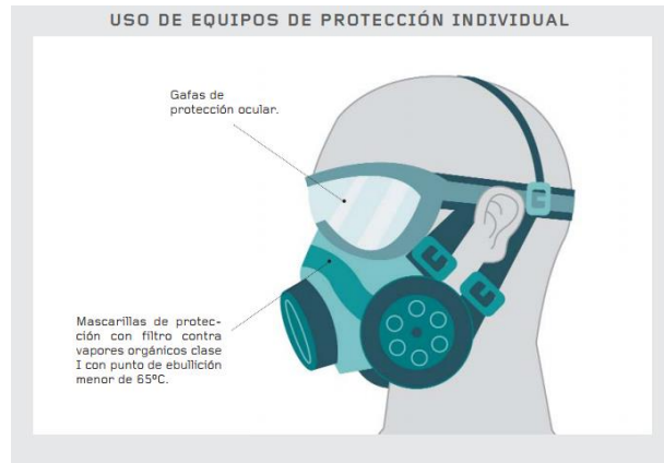
Ilustración 4: Uso de Elementos de protección Personal Facial (respirador con filtro, monógrafas)
