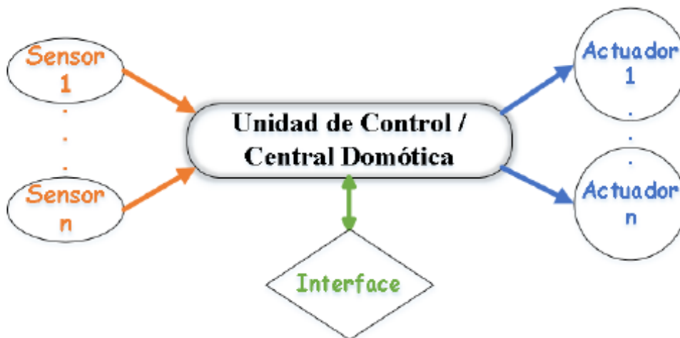
Figura 9. Sistema de control centralizado
