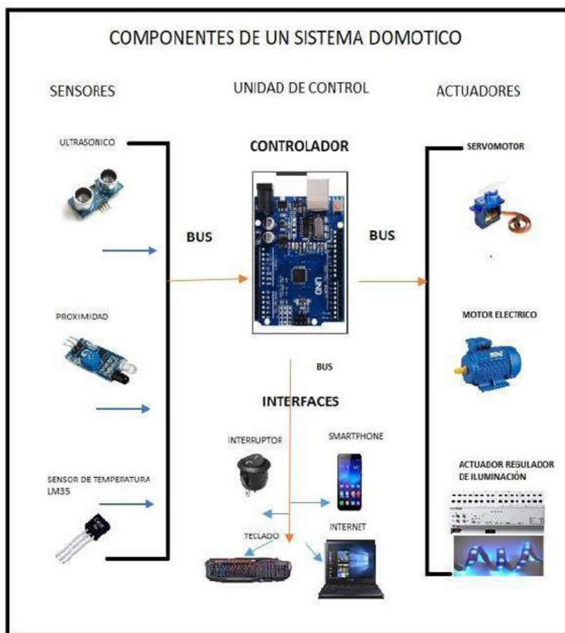
Figura 8. Componentes de un sistema domótico
