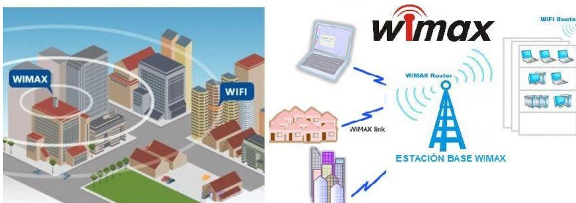
WiMax proporciona una conectividad muy idéntica al ADSL por cable tradicional, pero sin cables, lo que hace fácil la integración entre equipos. WiMax significa Interoperabilidad Mundial para el Acceso por Microondas. Wimax no requiere conexiones de cable entre terminales de suscriptores y estaciones base Wimax, lo que permite que una sola estación base admita cientos o incluso miles de suscriptores. Entonces sabrás cómo funciona. Diferencia entre LAN inalámbrica y WiMax
