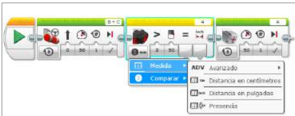
Figura 5. Sensor ultrasónico EV3 – Programación.
