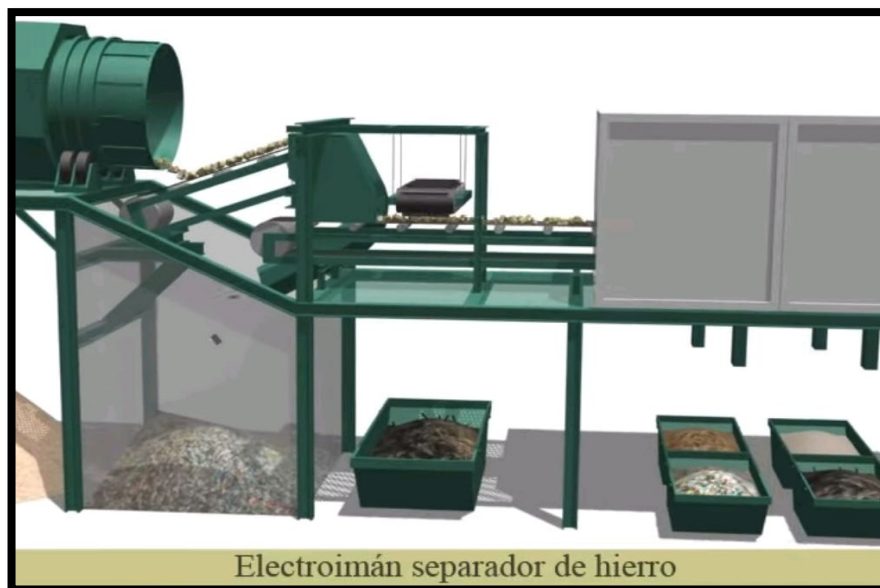
Figura 24. Electroimán separador de hierro. Fuente tomado de video planta de tratamiento de RCD
