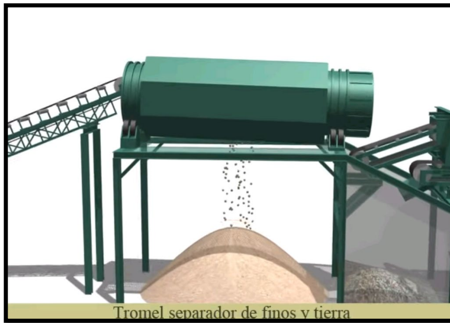
Figura 22. Tromel separador de finos y tierra. Fuente tomado de video planta de tratamiento de RCD
