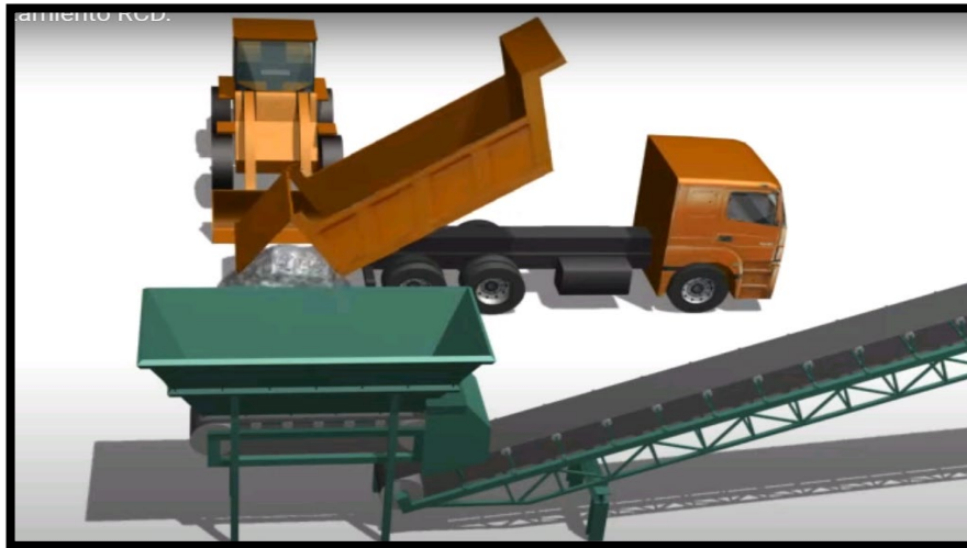
Figura 18. Recepción de RCD. Fuente: tomado de video planta de tratamiento de RCD
