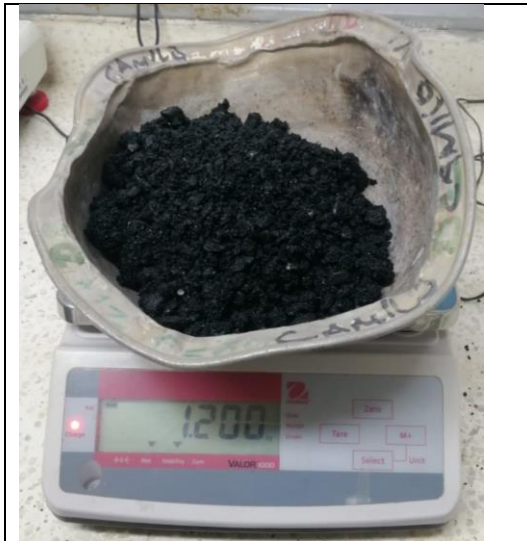
Imagen 4 1,2 kg de mezcla convencional asfáltica Fuente: Autores
