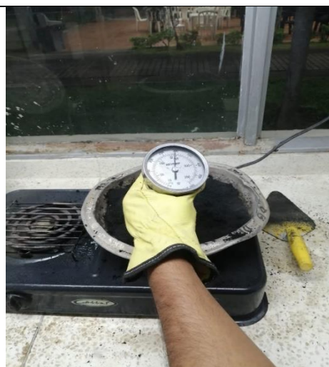
Imagen 9 comprobación de temperatura del GCR Fuente: Autores
