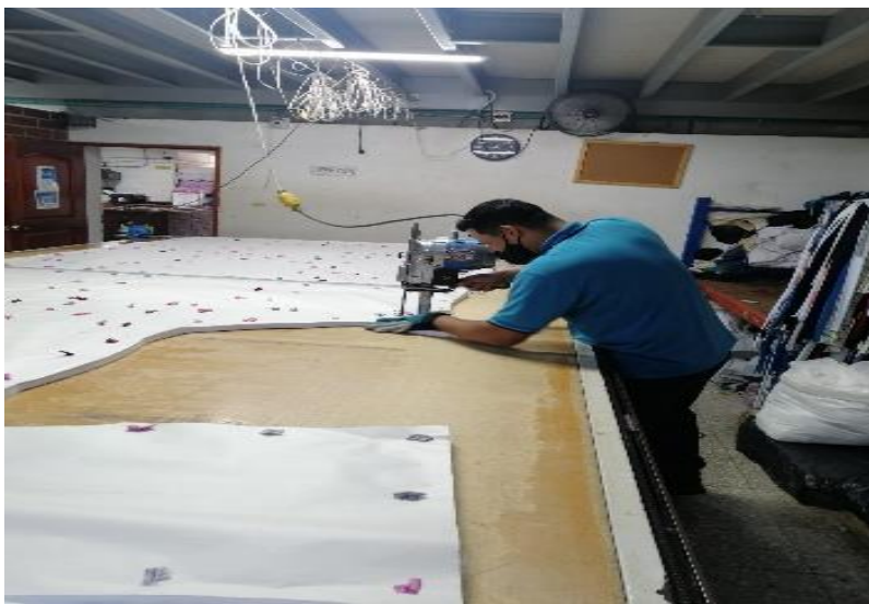
Figura 16. Corte trazo abierto. Fotografía propia.
