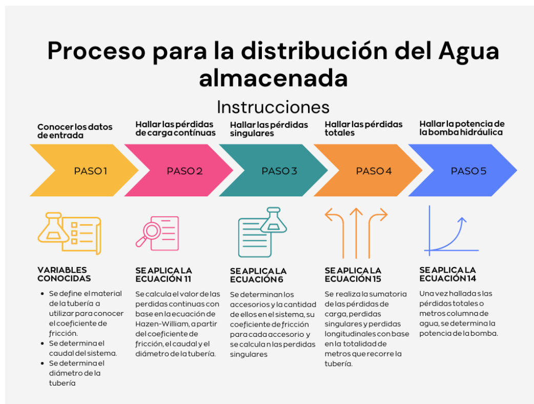
Ilustración 13 Procedimiento para la distribución del agua almacenada
