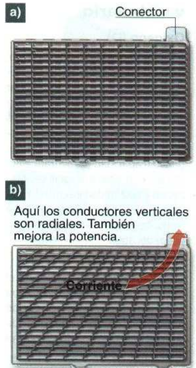
↑ Figura 2.9. Tipos constructivos de rejillas.
