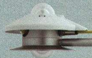
↑ Figura 1.49. Albedómetro. (Kipp&Zonen).
