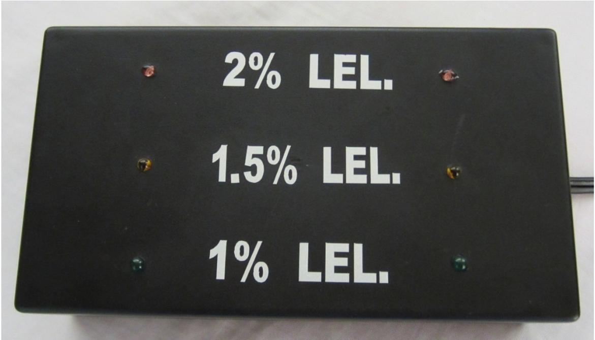
Fotografía sensor de gas metano para minas de carbón
