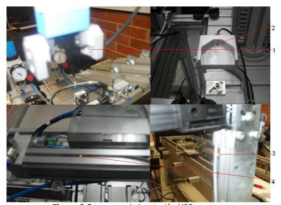
Figura 2.3 sensores de la estación MPS
