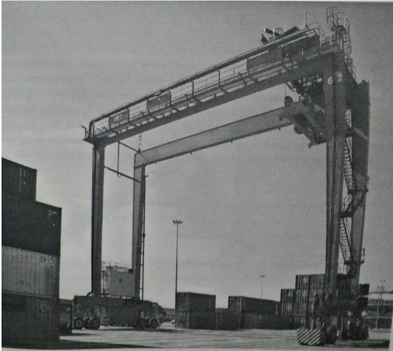
Ilustración 2-grúa pórtico de tierra provista de 16 ruedas neumáticas (Jaime Rodrigo, 2014)
