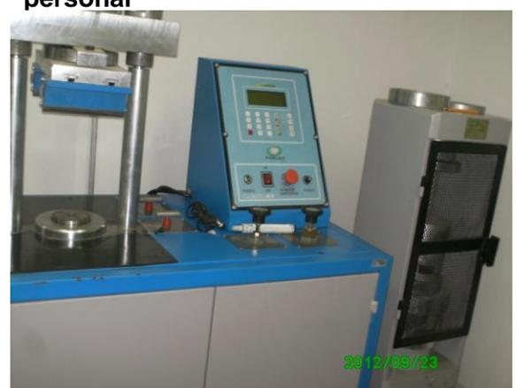
Foto 6 Máquina Digital Doble Rango Para Ensayos De Concretos
