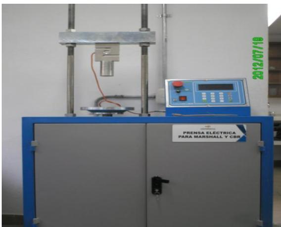
Foto 7. Prensa Eléctrica para Marshall y CBR
