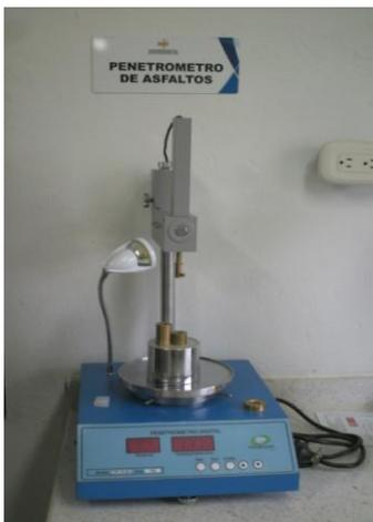
Foto 14. Penetrometro de asfaltos
