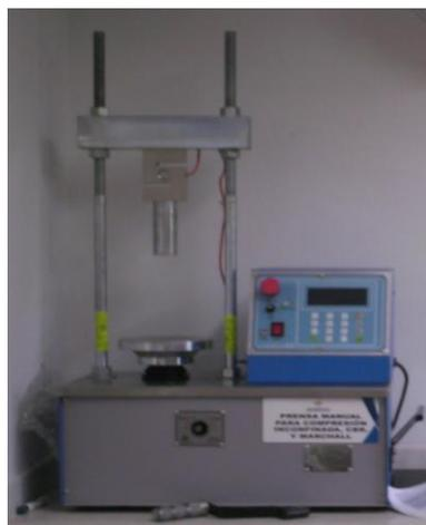
Foto 15. Prensa para Compresión Inconfinada, CBR y Marshall
