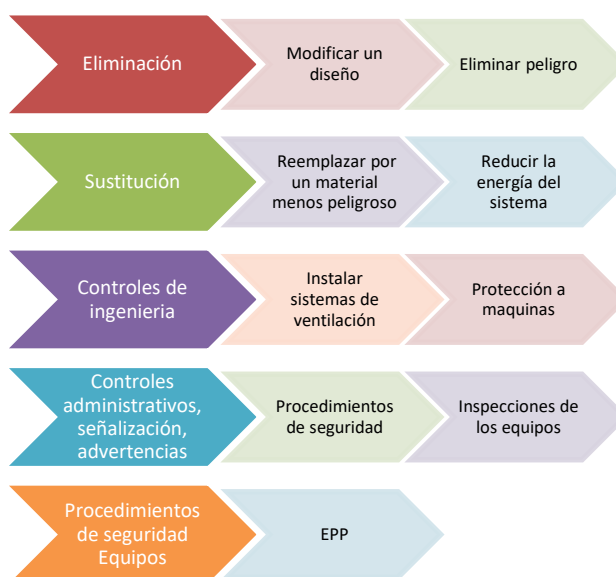
Figura 20: Medidas de intervención. Fuente: GTC 45
