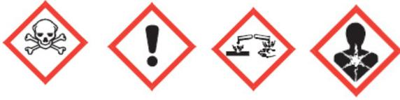
Figura 100. Etiquetado de sustancias según la clasificación del SGA sobre los peligros para la salud.
