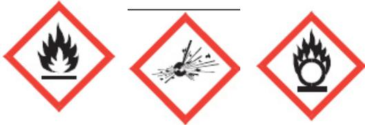
Figura 11. Etiquetado de sustancias según la clasificación del SGA sobre los peligros físicos.
