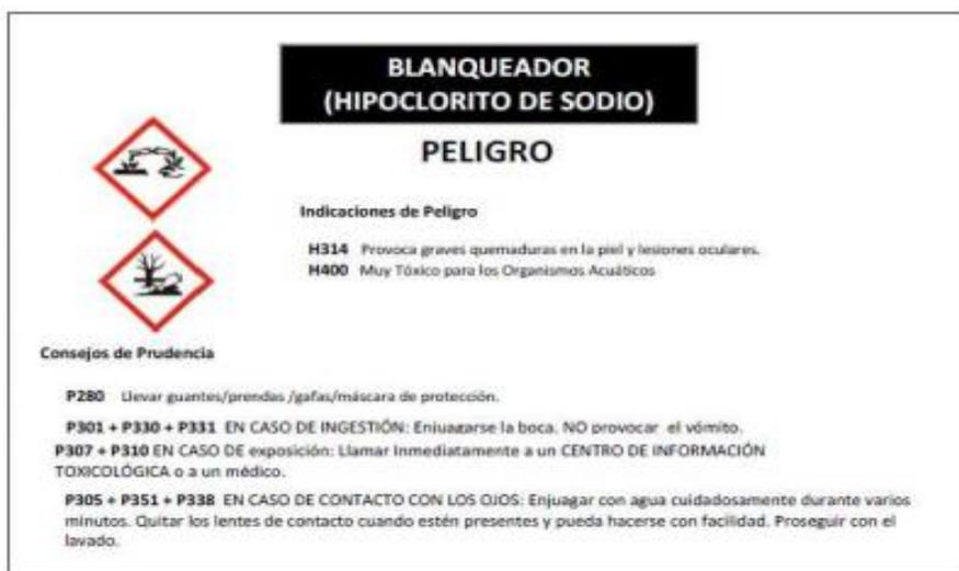
Figura 4. Ejemplo de una etiqueta SGA
