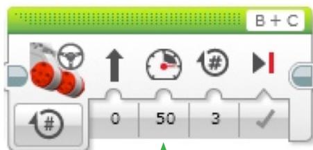
Este valor representa la relación de fuerza y velocidad con la que los dos motores van a operar, de esta manera, entre mayor sea el valor los motores darán mas RPM (mayor velocidad) y tendrán una mayor fuerza de arranque. Si el valor del parametro es negativo (menor que 0) los motores girarán de manera inversa cumpliendo la misma relación de fuerza y velocidad descrita anteriormente.
