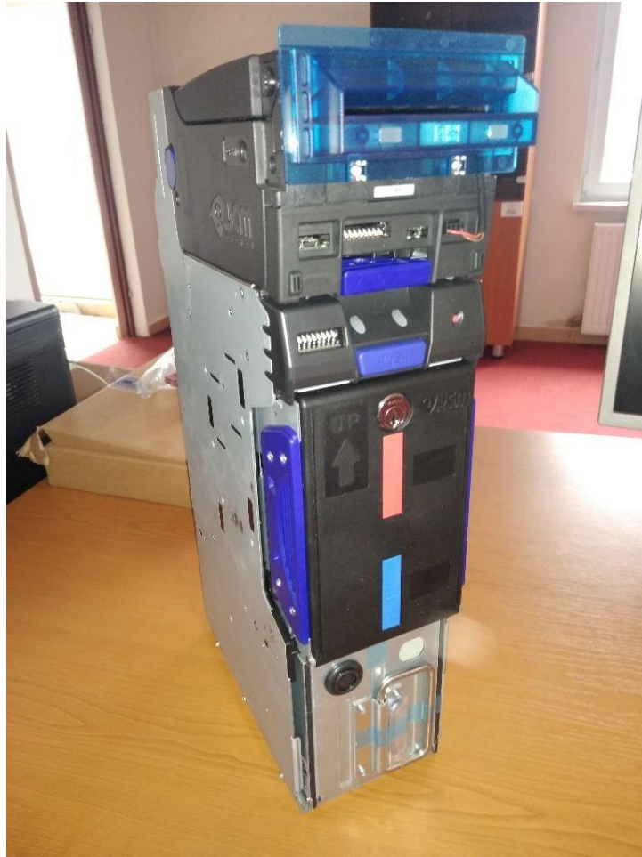
Figura 32. Este es el billeteero antiguo Ref IPRO.100.SH2-RQ que tienen el 100% de los cajeros Horus el cual actualmente tiene el cliente Centro Comercial Tintal Plaza.
