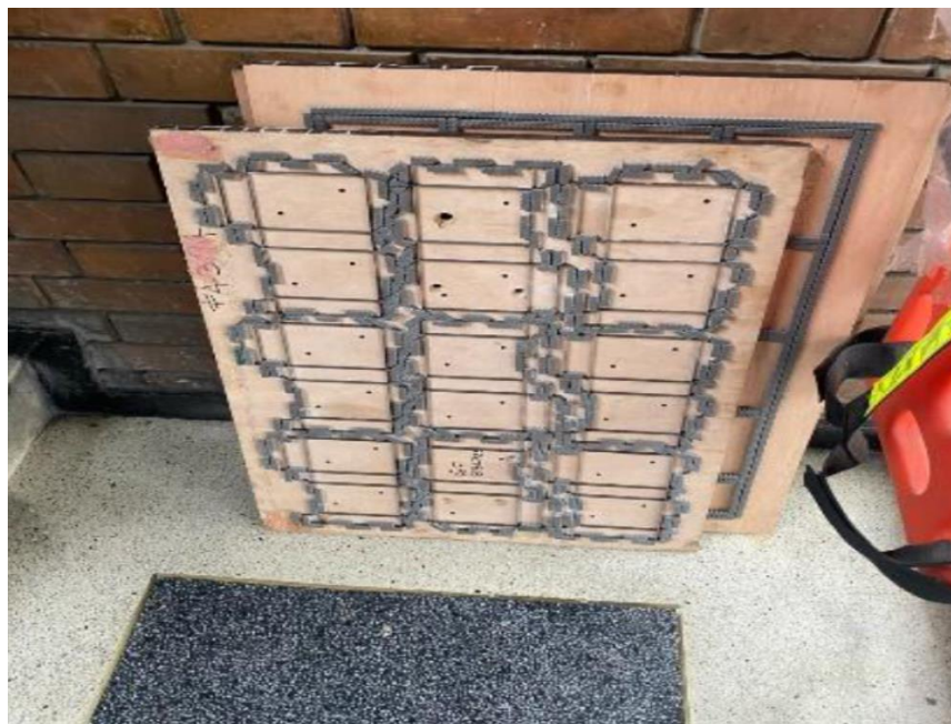
Ilustración 3 Troqueles usados en Planta
