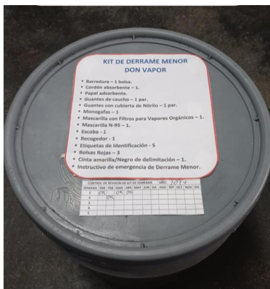
Foto del listado de elementos del Kit de Derrame Menor y registro de Inspección.
