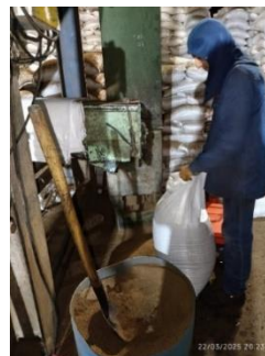
Ilustración 8 Finalización del llenado y retiro del saco de la boca distribuidora.
