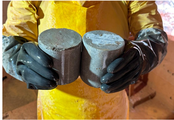
Figura 61. Corte del cilindro para adoquín.
