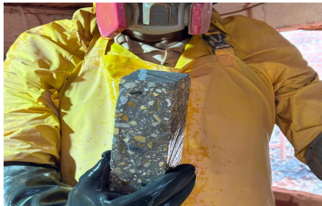
Figura 60. Corte del cilindro para mampuesto.
