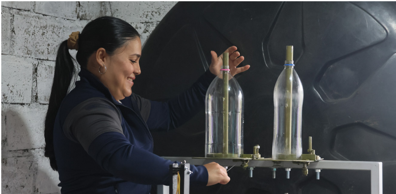
Máquina para obtención de filamento a base de botellas PET diseñada por Jeimy Chicunque, miembro de ASOPROVALT y estudiante del semillero de investigación GISI - Unicomfauca.
