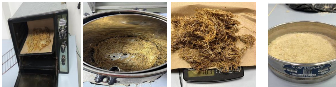
(Figura 18. Horno de secado) (Figura 19. pluma hidrolizada) (Figura 20. pesado post-hidrólisis) (Figura 21. tamiz)
