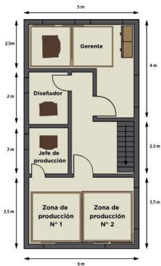
Figura 28. Diseño de la planta física – Segundo piso
