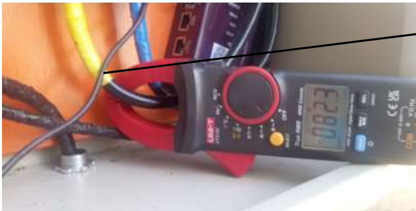
Ilustración 2Falla Sobrecarga Amperaje
