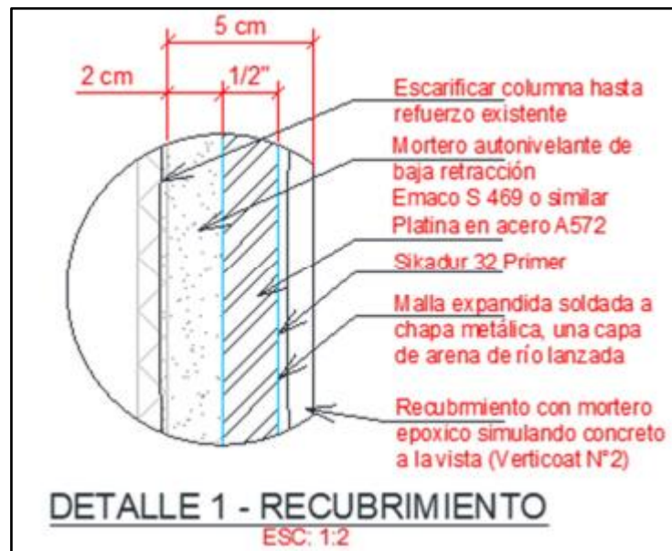
Figura No. 7. Detalle reforzamiento columnas con chapas metálicas
