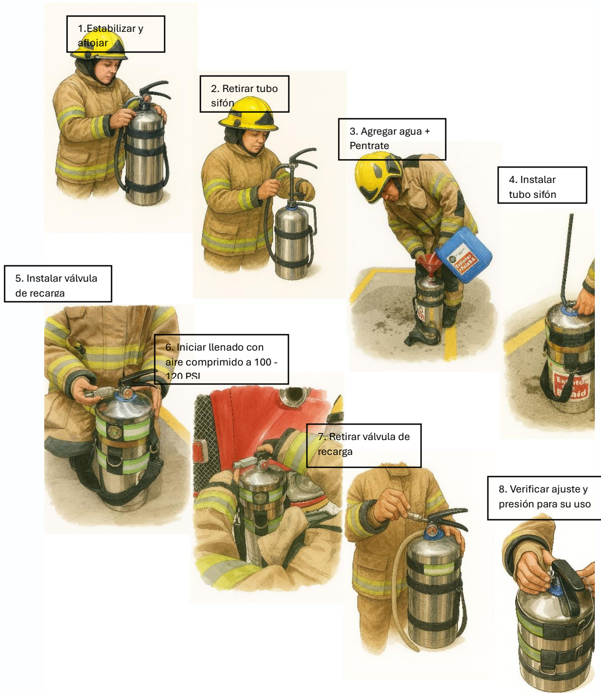
Figura 3: Proceso de recarga in-situ del sistema de extintor portátil de agua a presión recargable
