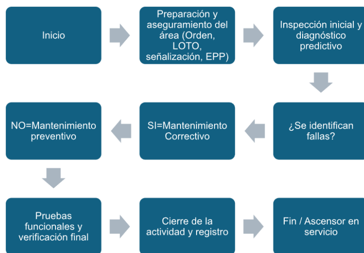
Ilustración 1. Flujo de proceso Mantenimiento preventivo y correctivo
