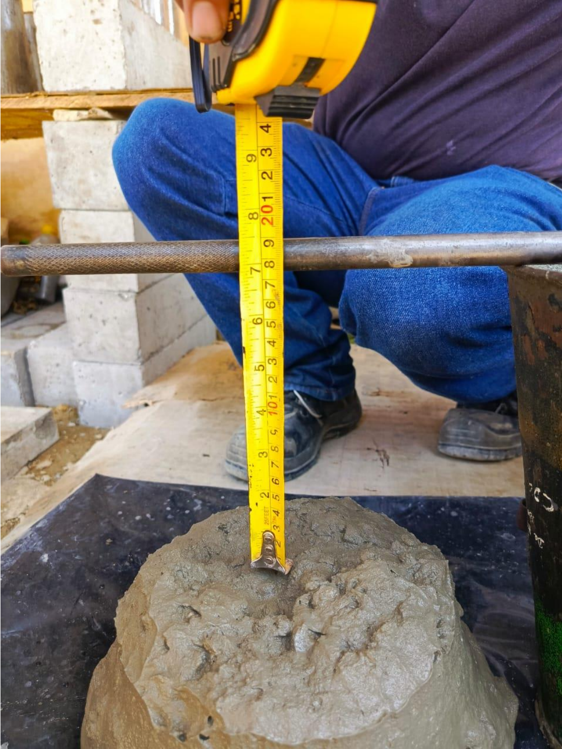
Figura 4. Ensayo de asentamiento (NTC 396)
