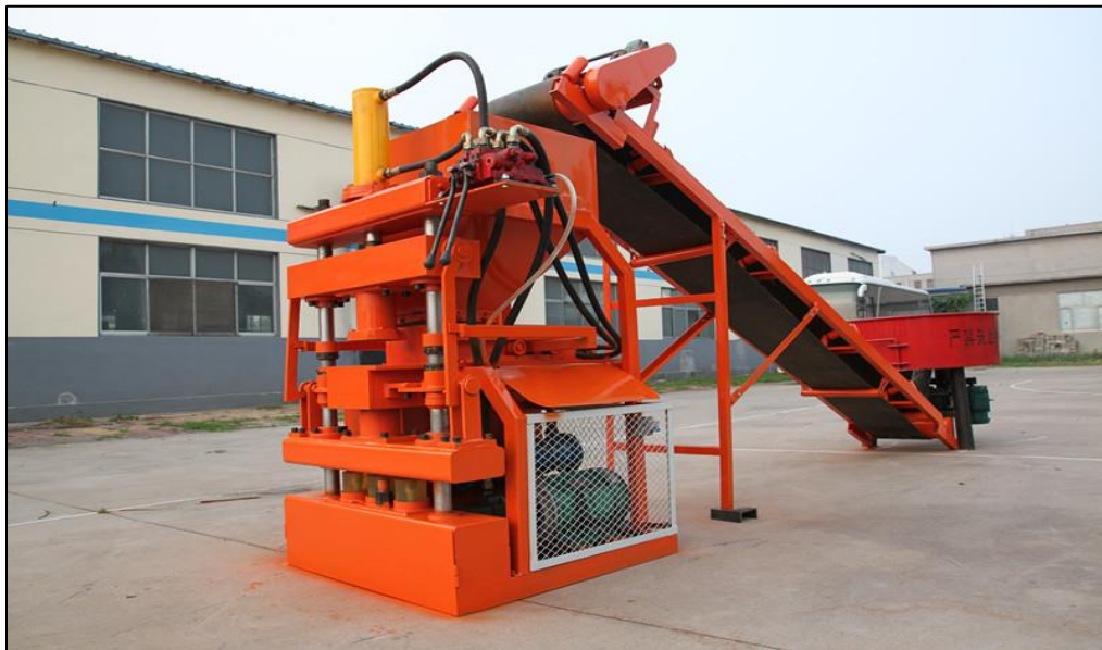
Ilustración 1. Prensa Hidráulica de Ladrillos Ecológicos Fuente: (Li, 2018)
