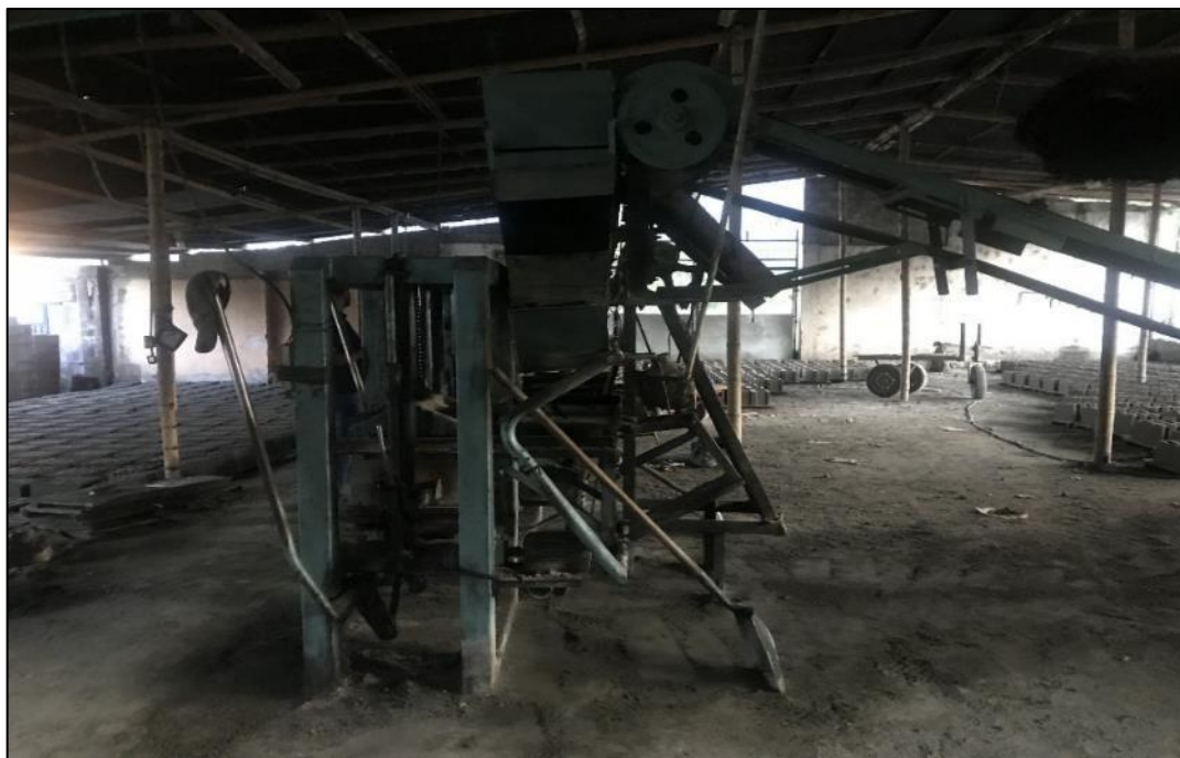
Ilustración No 32: Máquina vibro moldeadora Fuente: Autores.
