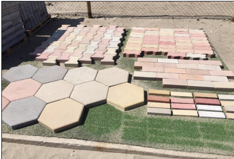
Ilustración 10: Ladrillos y adoquines hechos de las cenizas de termoeléctricas Fuente: (Mena, 2017)
