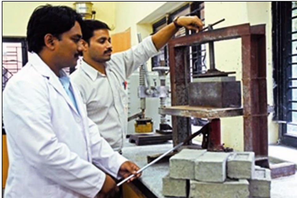
Ilustración 9: Ladrillos hechos con pasta de papel reciclados Fuente: (Alvarez, 2013)
