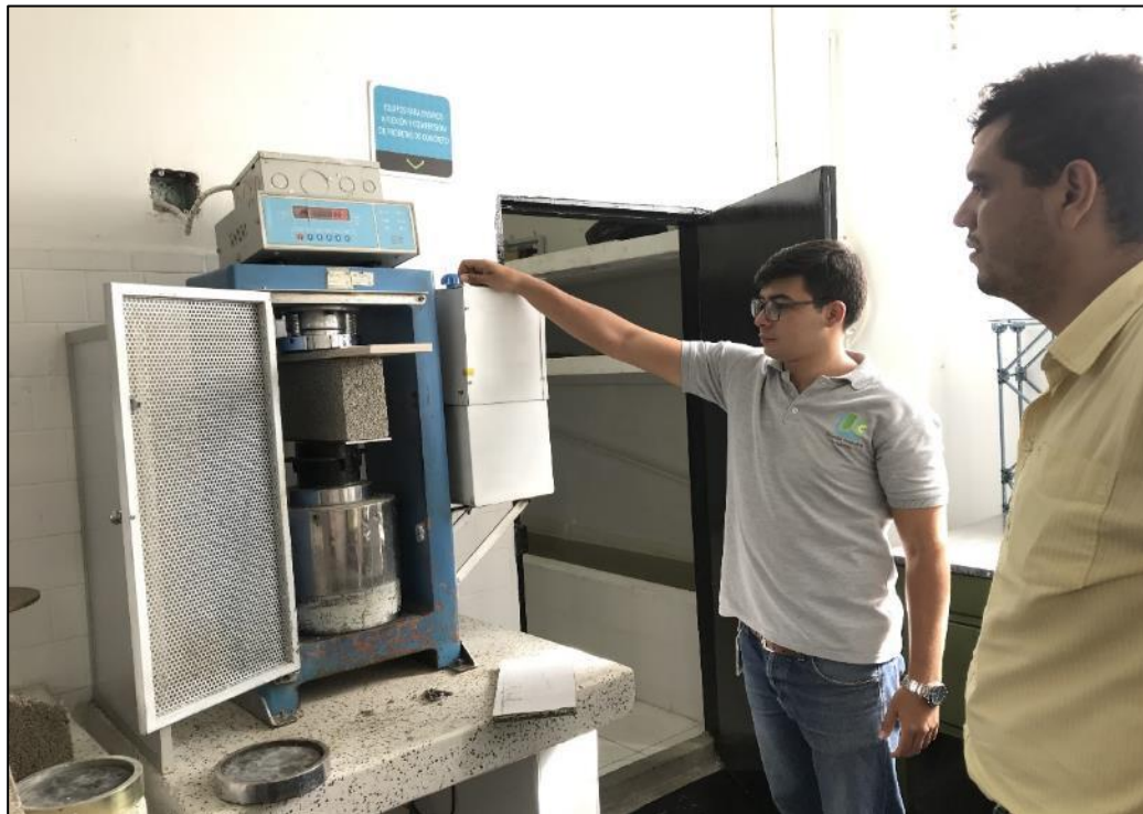
Ilustración No 41. Toma de ensayos a compresión. Fuente: Autores.
