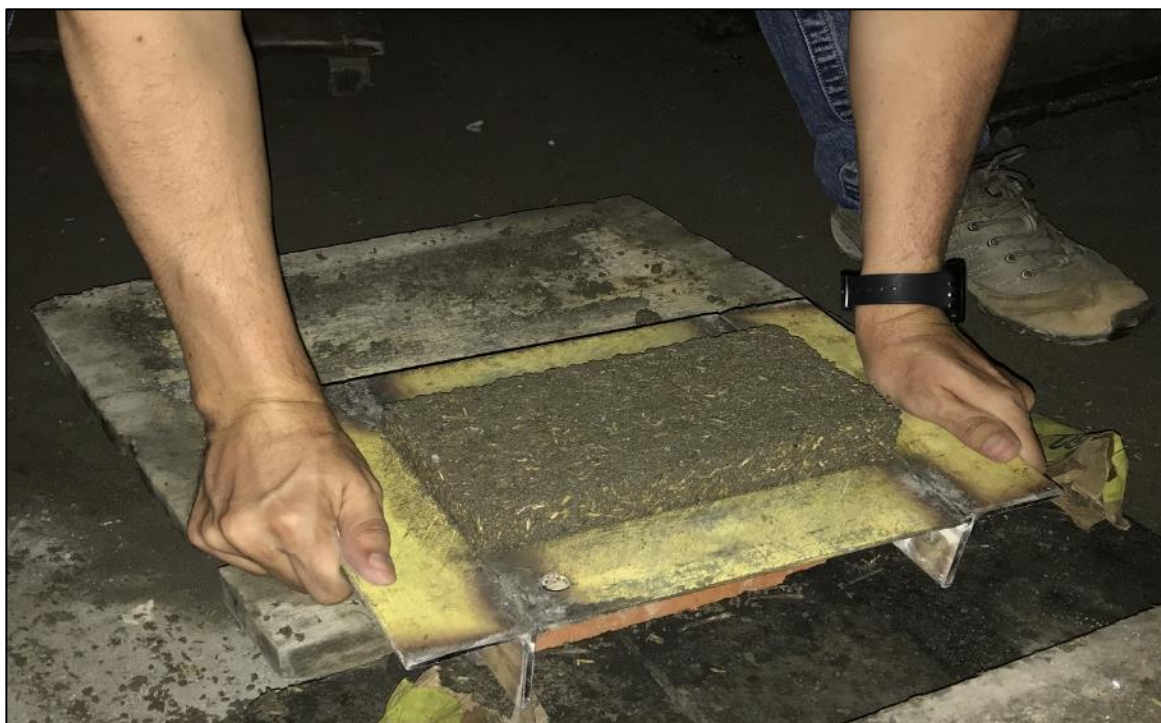
Ilustración No 39. Moldeado y compactación para la fabricación de Ladrillos. Fuente: Autores.
