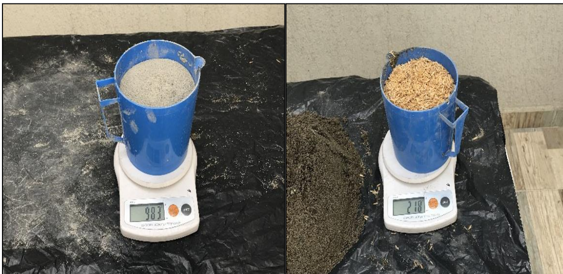
Ilustración No 34. Análisis de peso y volumen de los elementos a utilizar en la mezcla. Fuente: Autores.
