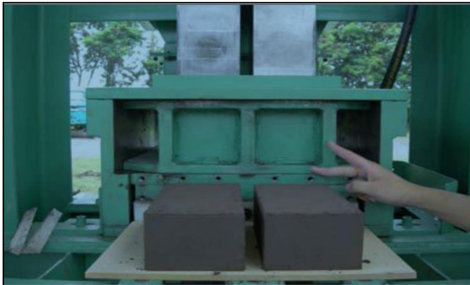
Ilustración 13. Ladrillos que contienen ceniza de carbón, escoria siderúrgica, escoria de cobre.
