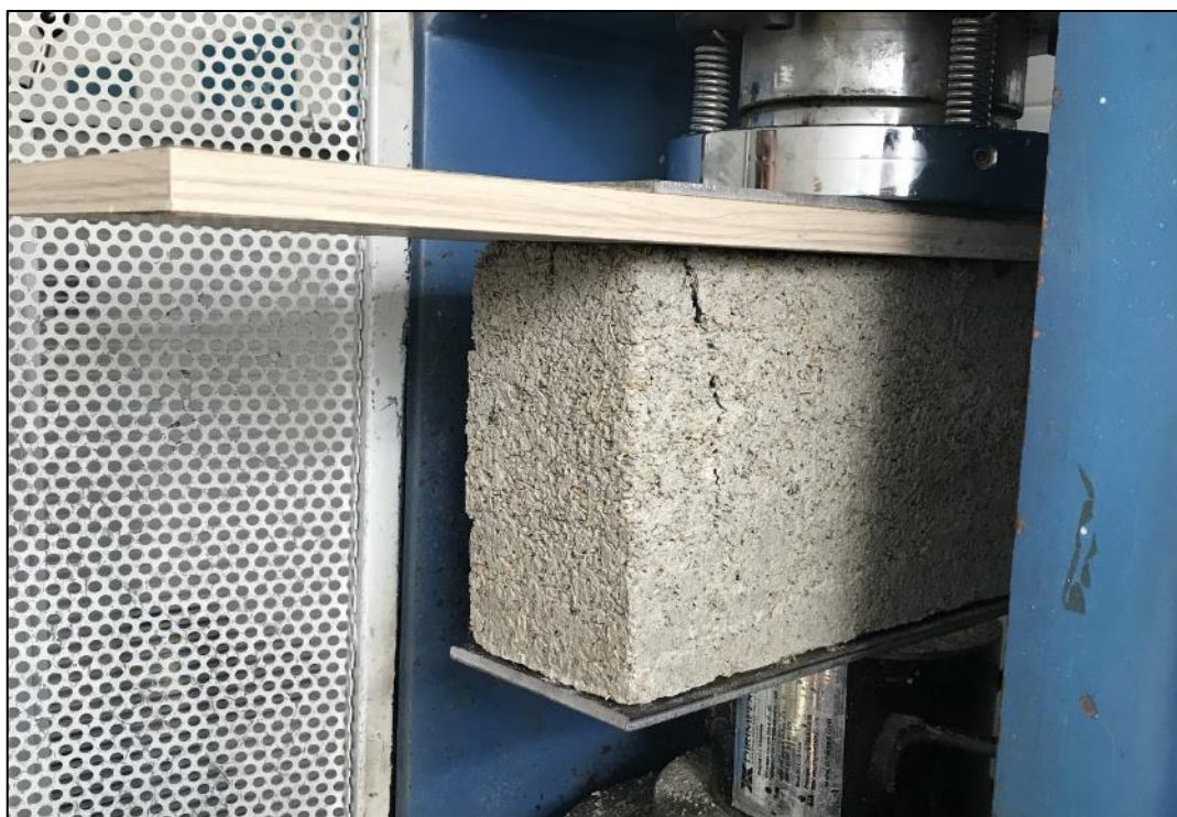
Ilustración No 42. Rotura por ensayo de Compresión. Fuente: Autores.
