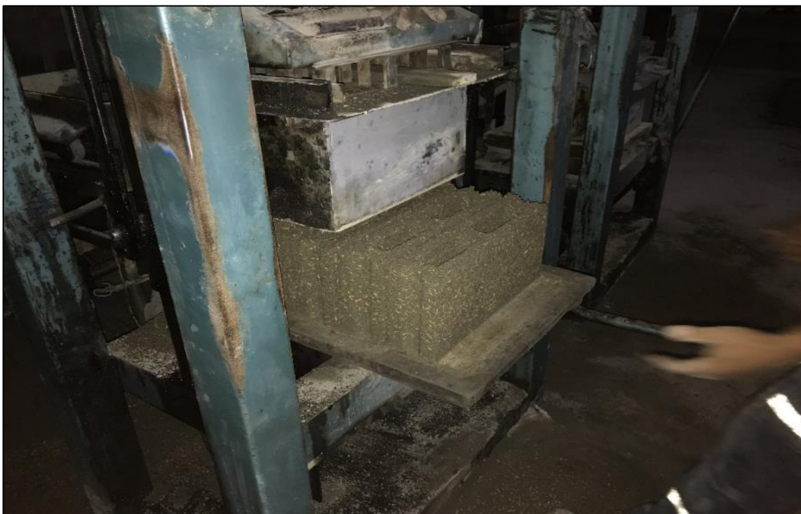
Ilustración No 38. Vibro moldeado para la fabricación de Bloques. Fuente: Autores.
