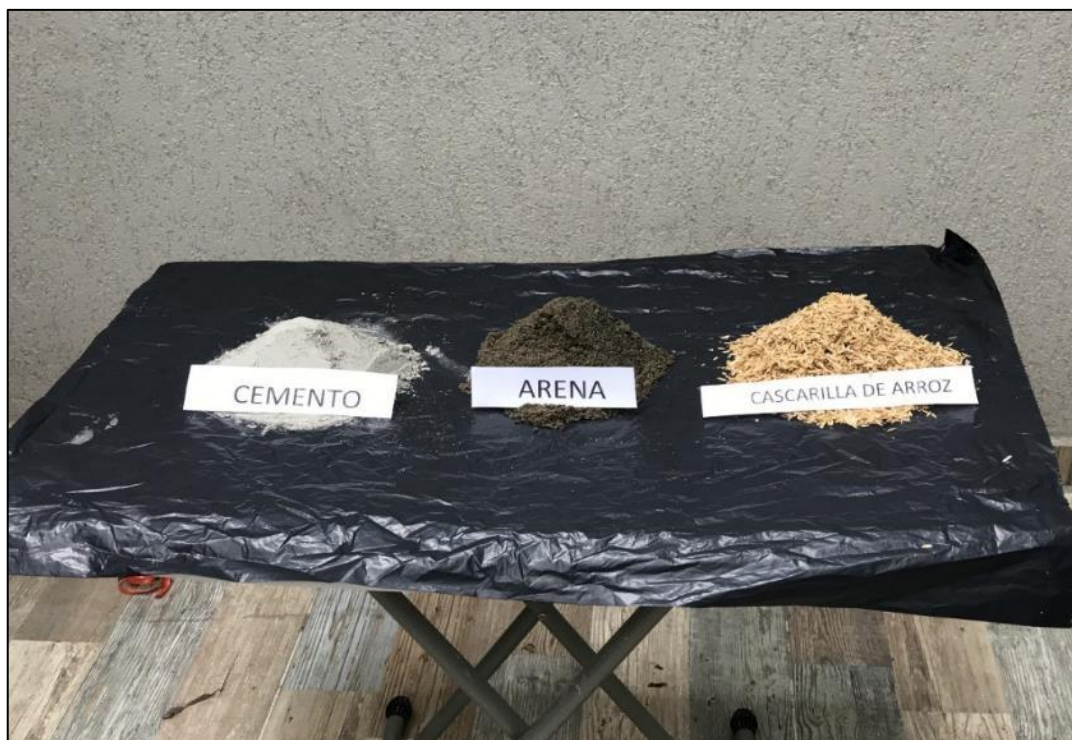
Ilustración No 33. Elementos utilizados en la fabricación de los ladrillos ecológicos Fuente: Autores.
