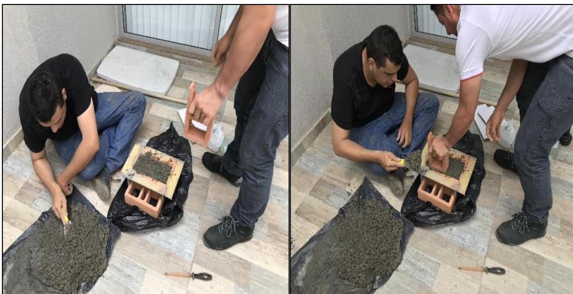
Ilustración No 37. Moldeado y compactación del material para fabricación de ladrillos
