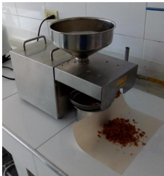
FIGURA 6. MÁQUINA DE EXTRUSIÓN OPM500W PARA AGUACATE PAPELILLO (CARREÑO, 2021)
