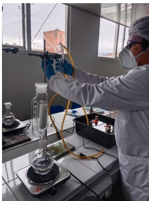
FIGURA 28 INSTALACIÓN MONTAJE DE DESTILACIÓN SOXHLET
