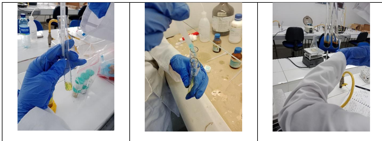
FIGURA 42 PRUEBAS DE MARCHA FITOQUÍMICA: FLAVONOIDES, CARBOHIDRATOS, Y ALCALOIDES
