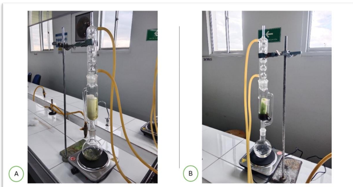
FIGURA 29 DESTILACIÓN Y EXTRACCIÓN SOXHLET: A) KALANCHOE PINNATA , B) SALIX HUMBOLDTIANA
