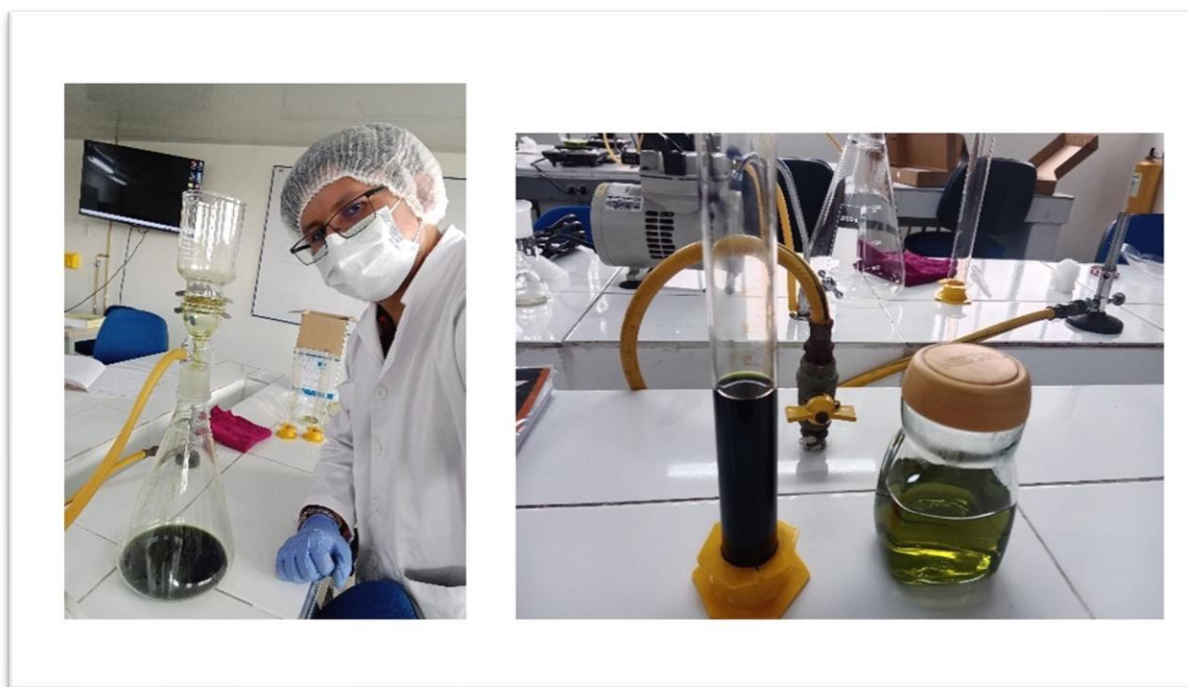
FIGURA 30 TÉCNICA DE FILTRACIÓN AL VACÍO PARA OBTENCIÓN DE EXTRACTOS FRACCIÓN A Y FRACCIÓN B: KALINCHOE PINNATA Y SALIXHUMBOLDTIANA
