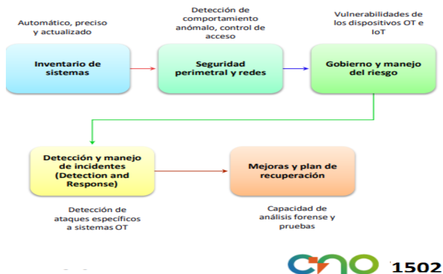
Figura 7 – Aspectos del Acuerdo CNO-1502 que son de uso Tecnológico y aplica el uso de Sensores basados en tecnología de Inteligencia Artificial - modo aprendizaje y alertamiento
