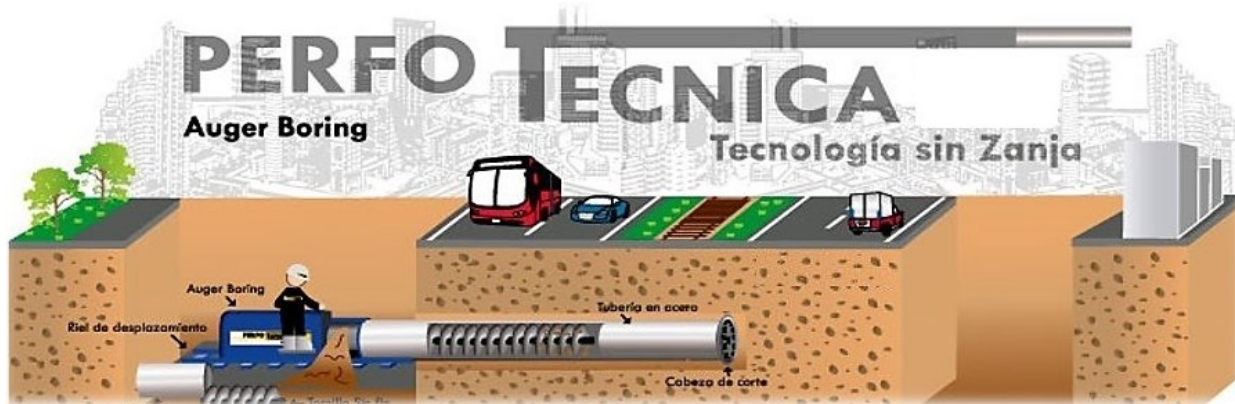
Ilustración 9. Perforación con barrena convencional (Auger Boring). Tomado de: https://perfotecnica.com.pe/auger-boring/
