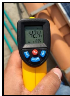
Figura 42. Medición de temperatura mediante medidor laser. Fuente: Autores
