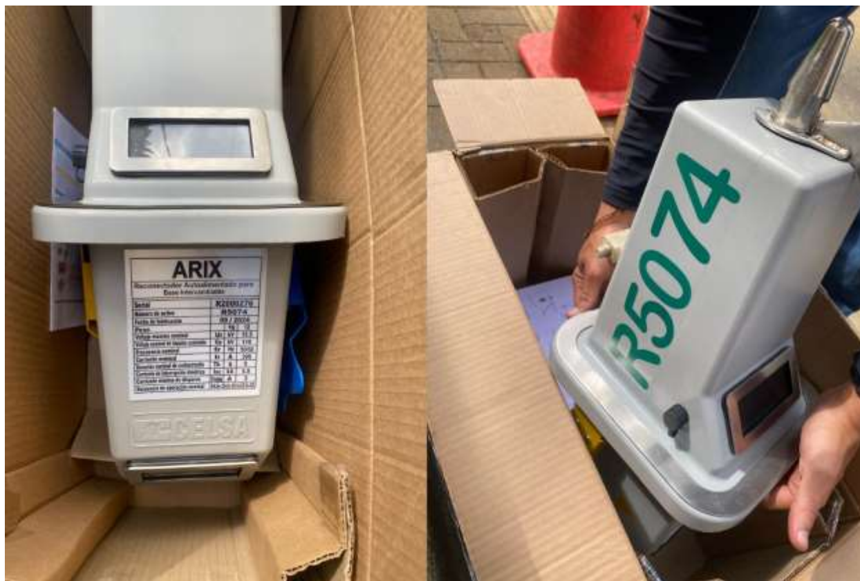
Figura 1A. Reconector monofásico autoalimentado (RMA).
