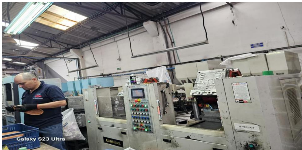
Figura 12 Verificación de máquinas inyectoras
