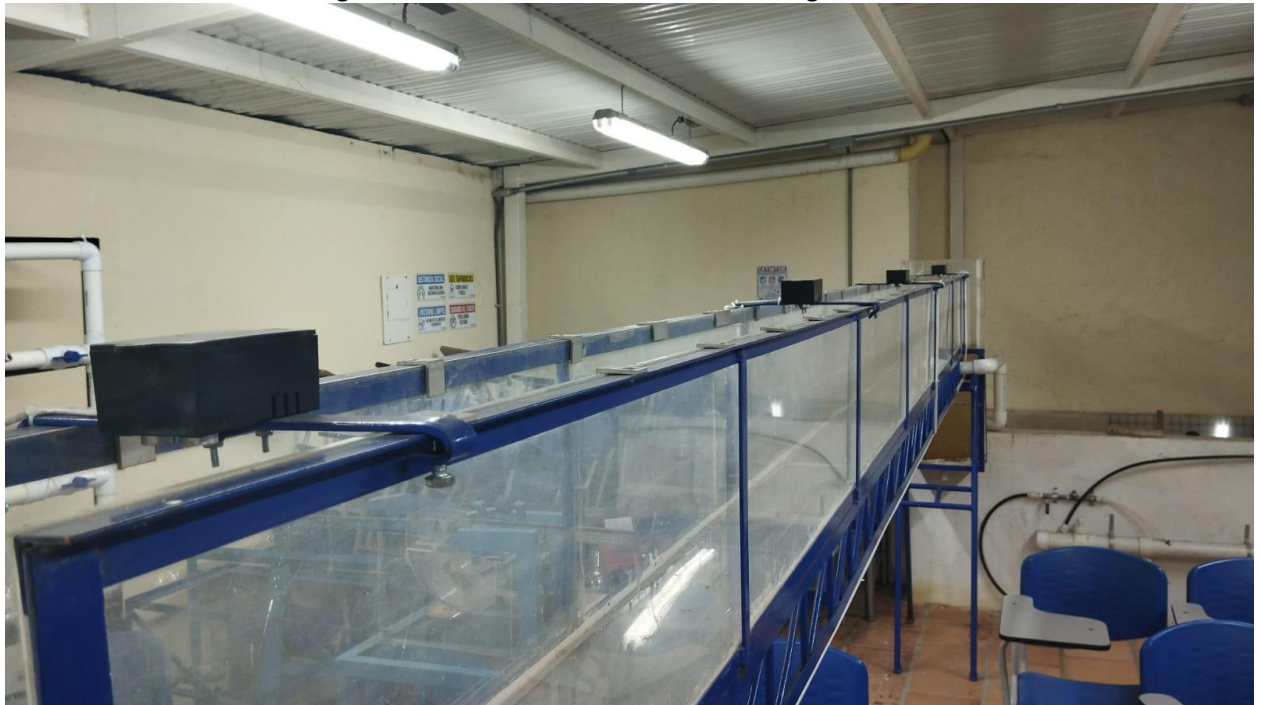
Figura 9 Sensores de nivel de lamina de agua
