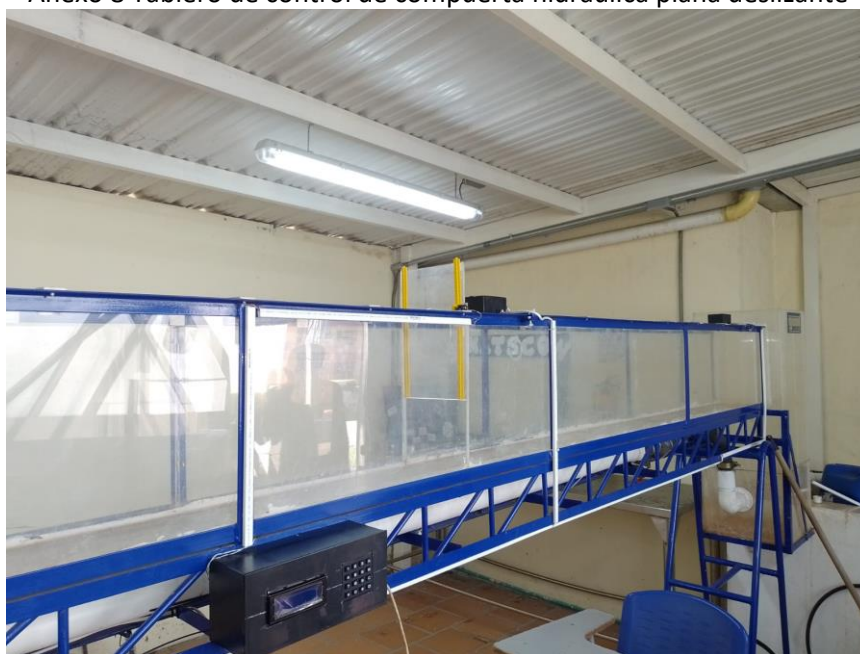
Anexo 8 Tablero de control de compuerta hidráulica plana deslizante
