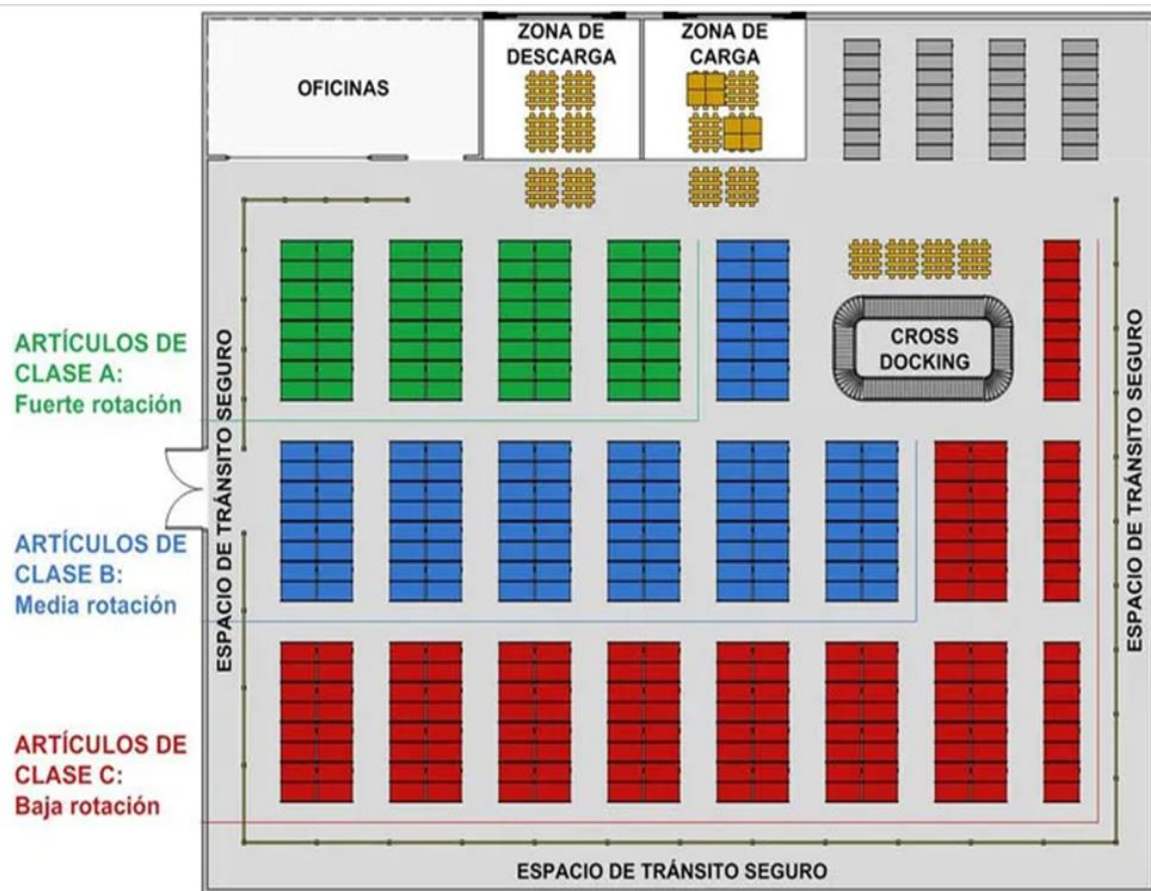
Figura 16. Diseño de Planta o instalaciones
