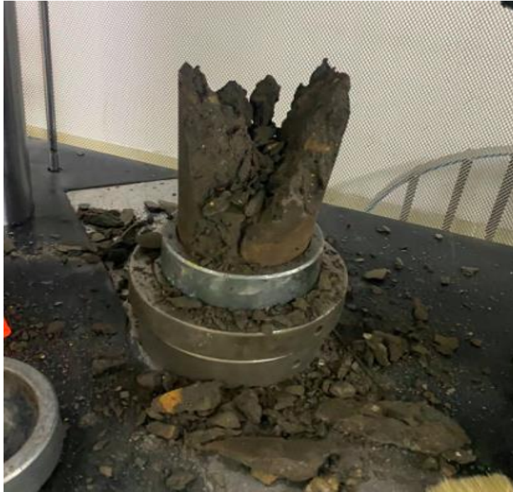
Anexo 8: Probeta de concreta fallada a compresión 2
