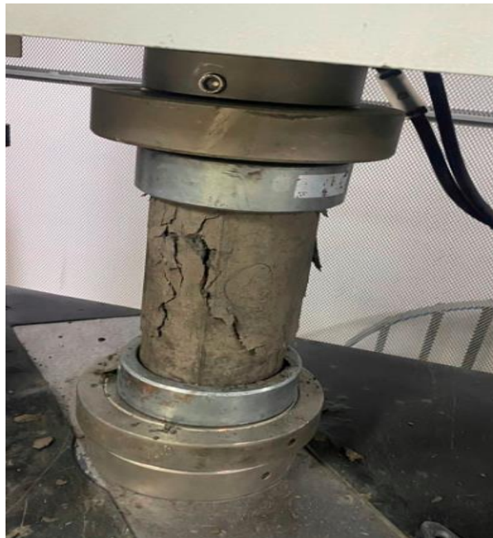
Anexo 7: Probeta de concreto fallada a compresión
