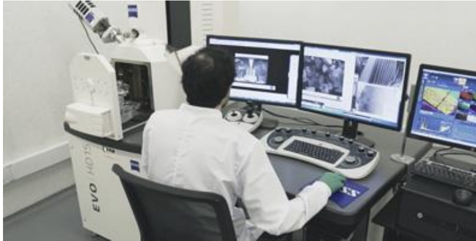
Imagen 6: Microscopio electrónico de barrido (SEM). Pontificia Universidad Javeriana. Zeiss evo HD 15.
