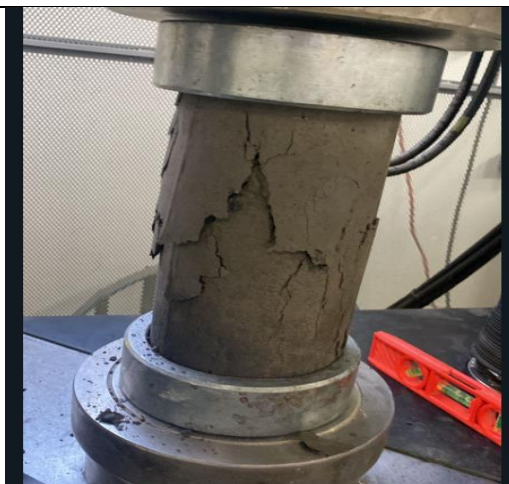
Imagen 19: Ensayo a compresión del cilindro.
