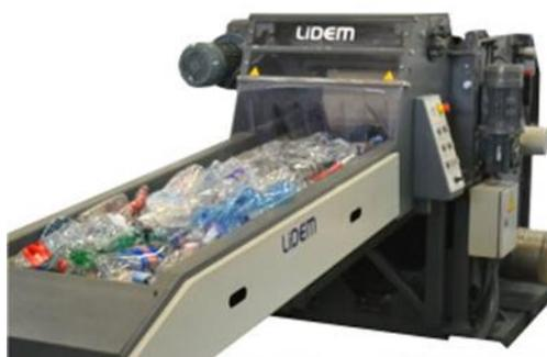
Nota. Muestra la maquina requerida para cortar y triturar los materiales plásticos reciclados. LIDEM, 2022.
