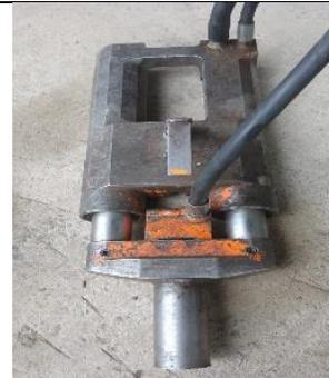
Bomba, gato hidráulico, cuña con cable de tensión. Accidente No 7, de la tabla 7
