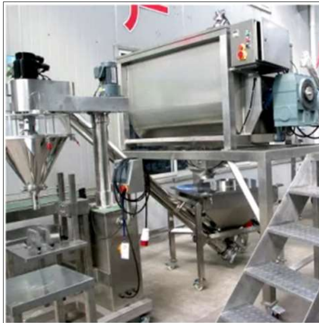
Imagen 10. Mezcladora industrial para la obtención de Bio resina
