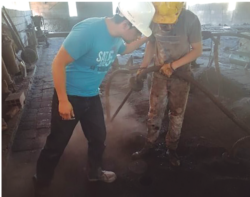
Figura 10. Proceso de alimentación del horno de ladrillo
