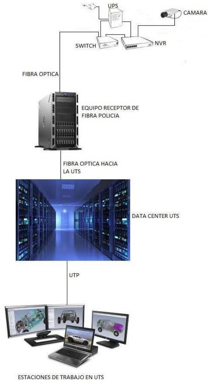
En este esquema se requiere que se cuente con equipos robustos para el almacenaje y procesamiento de los datos adquiridos. Adicional a esto se requiere un lugar para la instalación de dichos equipos, una arquitectura de red para el buen funcionamiento de los mismos y el cableado estructurado necesario.
