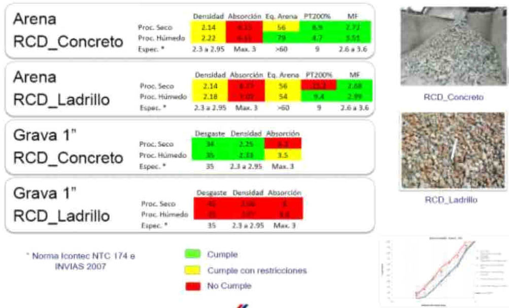
Ilustración 13. Caracterización de residuos áridos realizado por empresa cementera (Vega, 2012).
