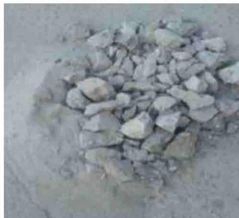
Fotografía. 6. Concreto fracturado para el análisis de laboratorio.
