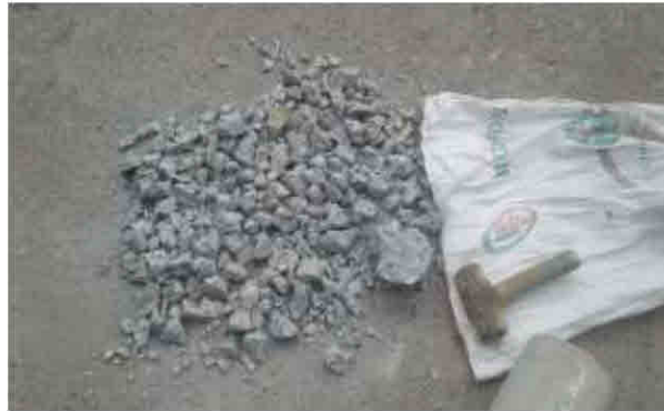
Fotografía. 7. Técnica de trituración manual (Fuente: Propia).
