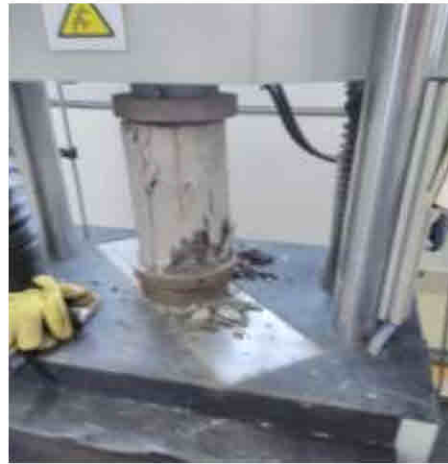
Fotografía. 9. Ensayo de compresión a cilindros de concreto reemplazando al 100% de la grava por material RCD (3000 PSI) (Fuente: Propia).
