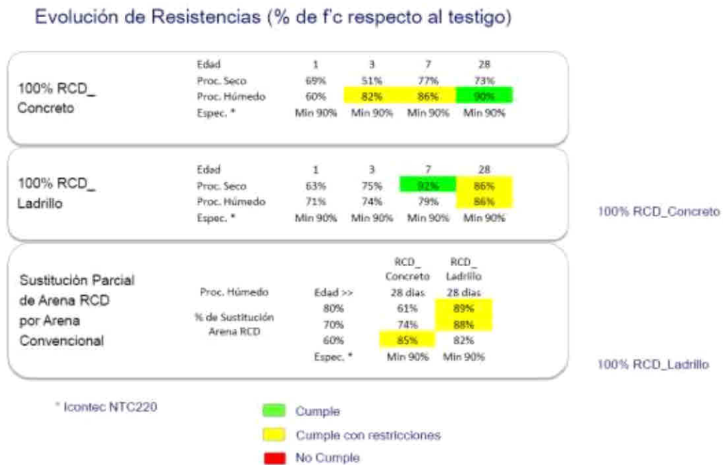
Ilustración 14. Evolución de resistencias en la caracterización de residuos áridos (Vega, 2012).
