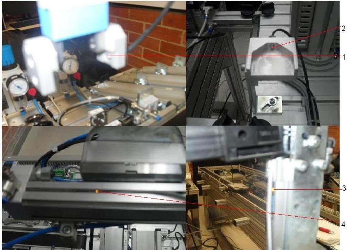
**Figura 2.3** sensores de la estación MPS
