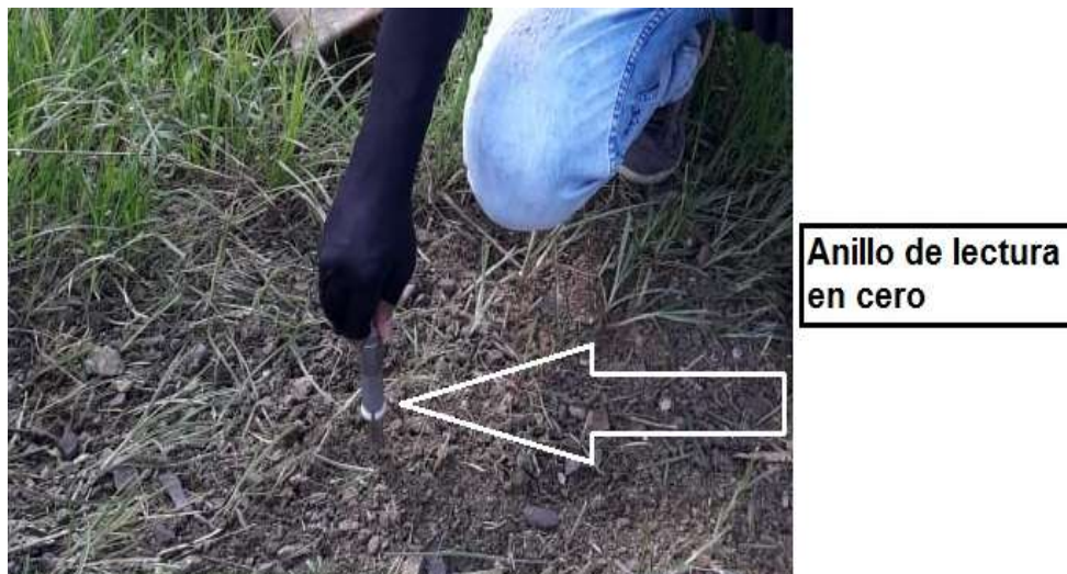
Ilustración 6. Ensayo de Resistencia a la Penetración (Penetrómetro de Bolsillo) Fuente: Elaboración propia, (2017)
