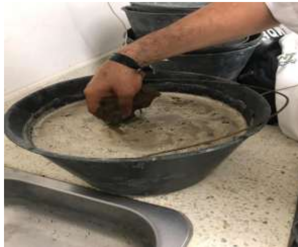
Ilustración 3. Lavado de la Muestra de suelo Fuente: Elaboración propia, (2017)
