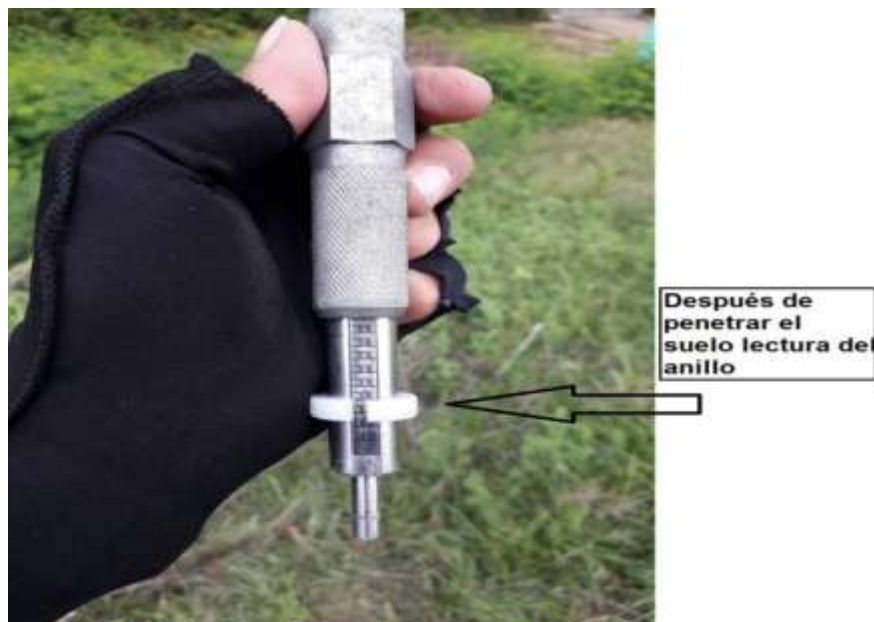
Ilustración 7. Lectura del anillo del Penetrómetro de Bolsillo Fuente: Elaboración propia, (2017)
