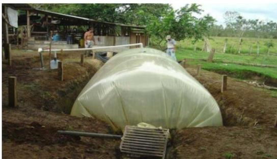
FIGURA 2. Biodigestor en bolsa doble de polietileno de bajo costo, modelo Taiwán, recién instalado (aún sin techo, ni cerca periférica), operando en una finca familiar.
