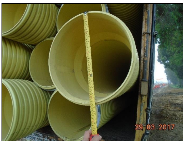
Tubería de agua residual de 16”
